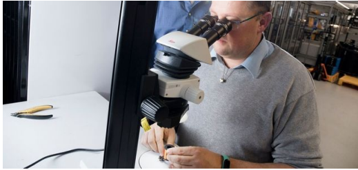
<p>Am Mikroskop prüft Bernd Pfadler den Lackabtrag.</p>
