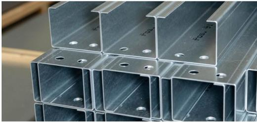
Genauere Produktanalysen der SCHRAG-Projektgruppe zeigen, dass manche Profile eine gewisse Standardisierung aufweisen. Diese Profile werden künftig automatisiert auf einer Rollprofilieranlage am SCHRAG Standort Hamburg Seevetal gefertigt.
