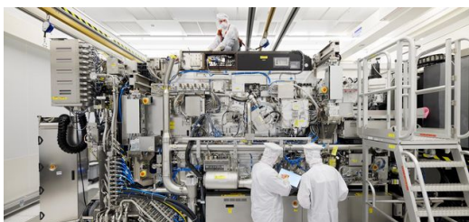
<p>ASML-Mitarbeiter arbeiten an einer neuen Generation des EUV-Lithographiesystems NXE3400B.</p> – ASML
