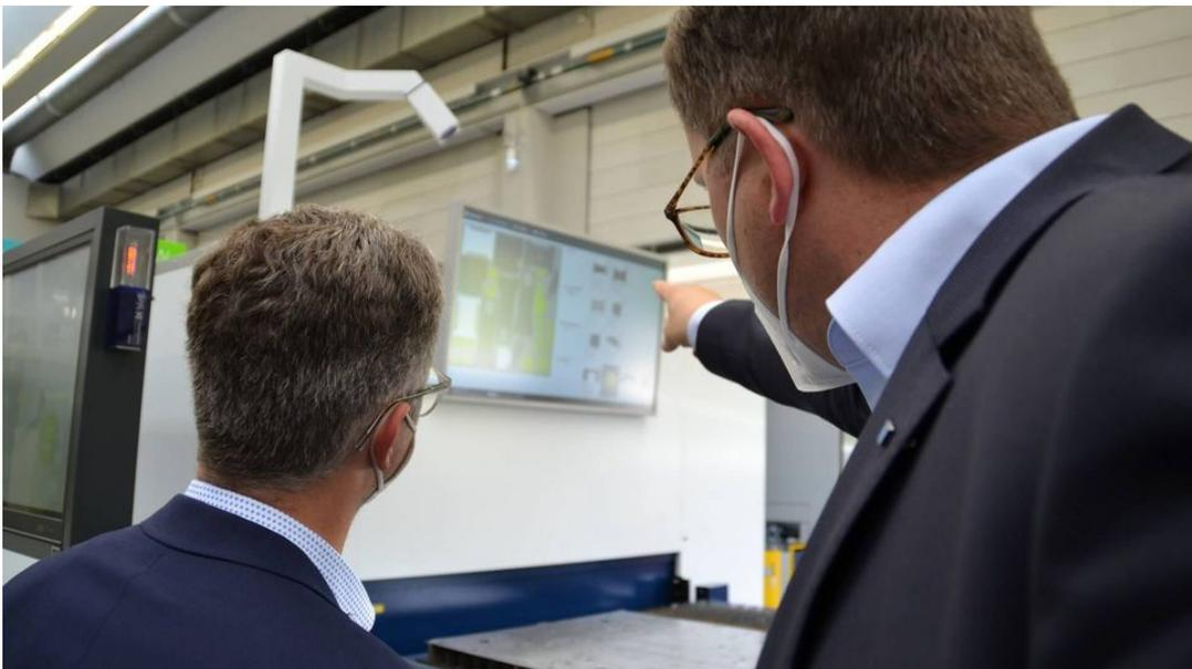
Künstliche Intelligenz trifft auf Blech: Welches Bauteil gehört zu welchem Auftrag? Langes Suchen entfällt mit der TRUMPF Lösung Sorting Guide. Der Mitarbeiter sieht dank smarterer Kameras auf dem großen Bildschirm, welche Bauteile zusammengehören beziehungsweise wo er anpacken muss.
