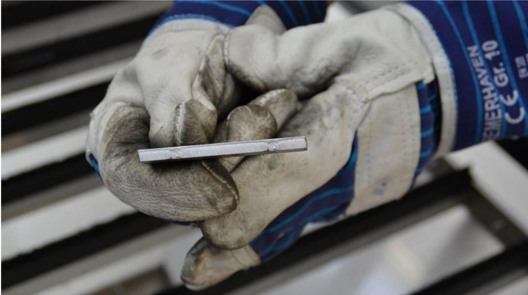
Vorteil Nanojoints II: Nachdem der Mitarbeiter die Bauteile aus der Blechtafel herausgetrennt hat, ist kaum noch eine sichtbare Verletzung an der Kontur der Bauteile zu erkennen. Der Mitarbeiter muss nicht mehr oder nur noch minimal per Hand nacharbeiten. Das spart Zeit und das Personal kann sich um andere Aufgaben kümmern.
