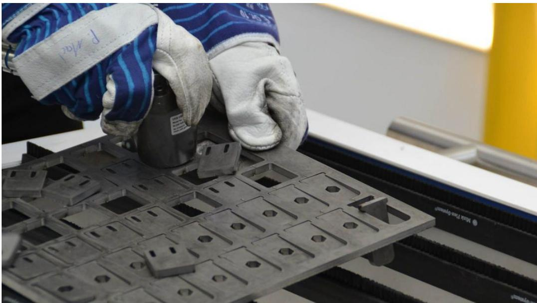
Vorteil Nanojoints I: Um die Teile zu entnehmen, muss der Mitarbeiter kaum Kraft aufwenden, die Arbeit geht leicht von der Hand und ist in Sekundenschnelle erledigt.
