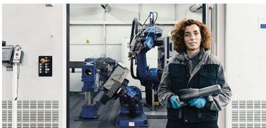
Die Laserschweißanlage TruLaser Robot 5020 erzeugt sehr schöne, feine Nähte mit dem Laser. Gerade in der Möbelindustrie, mit ihrem hohen Anteil an Sichtteilen, ist das ein wichtiges Kriterium. Das weiß auch die zuständige Mitarbeiterin Sandra Panedas. Luis Voces bezeichnet sie als absoluten Profi an der Anlage. (Foto: Niels Schubert)
