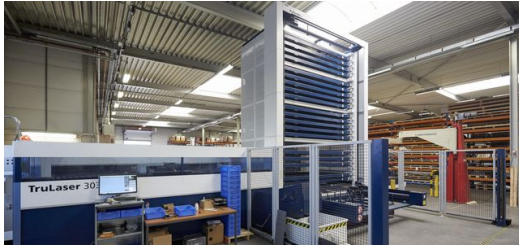
Die TruLaser 3030 schneidet die kleinen bis mittleren Serien, die Koridon hauptsächlich produziert (Foto: Claus Langer).
