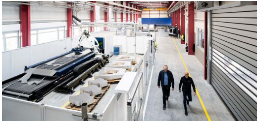
<p>Die 34 Meter langen Laserblanking-Anlage von TRUMPF spart Rohmaterial und rund 4000 Tonnen CO 2 pro Jahr.</p>
