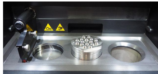
Preforms in TruPrint 1000: Vorrichtung mit Preforms im Bauraum des 3D-Druckers TruPrint 1000.
