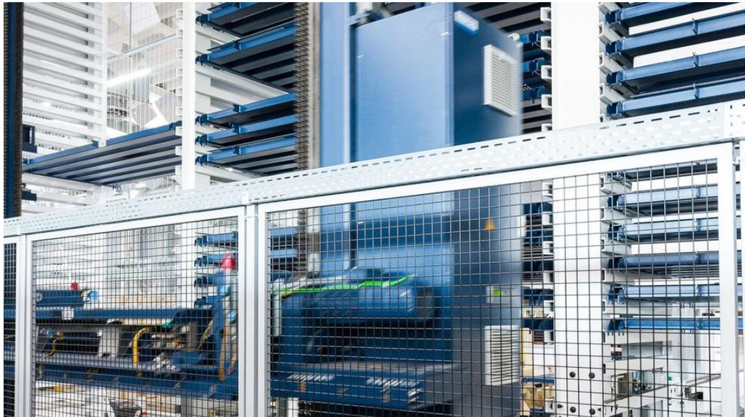
Das Regalbediengerät ist in der Mitte des Lagers auf Schienen angebracht und kann Lagerplätze blitzschnell vertikal und horizontal anfahren.
