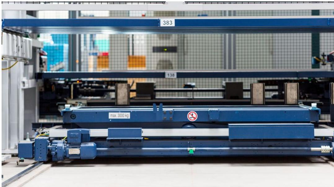
Paletten versorgen die angebundenen Anlagen mit Rohmaterial und lagern fertige Teile wieder zurück.
