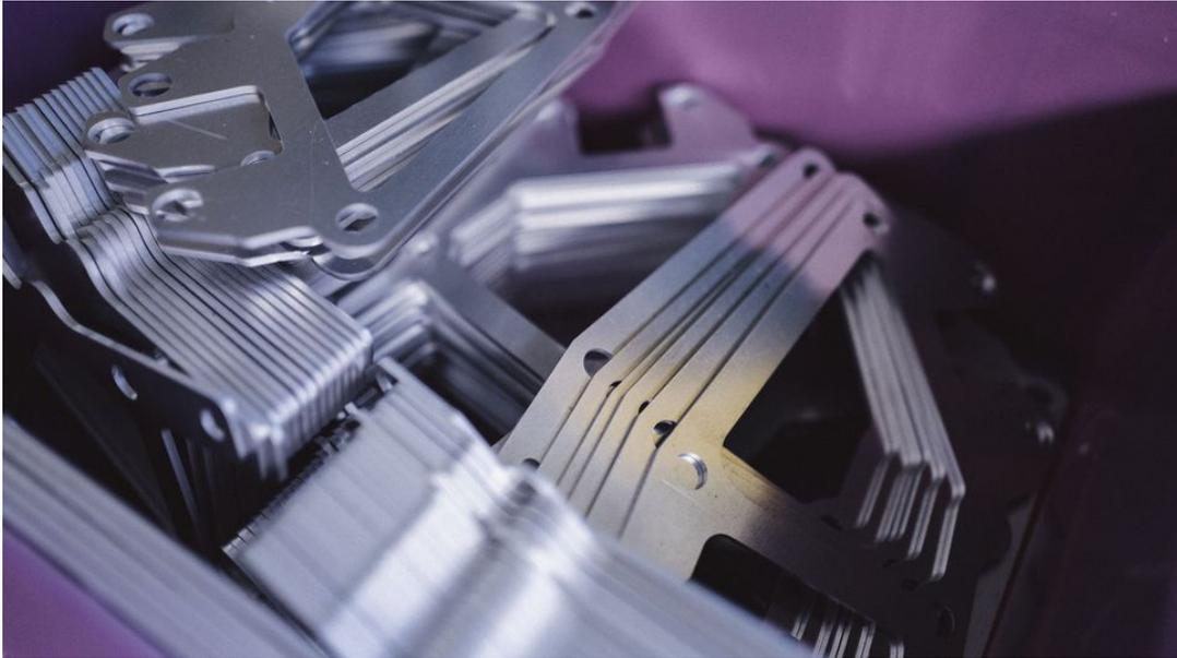
Eine große Erleichterung: Ein am Schneidkopf angebrachter Ausdrückzylinder unterstützt das Lösen kleinerer Blechteile aus dem Restgitter. Eine einfahrbare Sortierweiche fängt Gutteile auf und der SortMaster Box Linear verteilt sie auf bis zu acht Behälter, unterhalb der Maschine.
