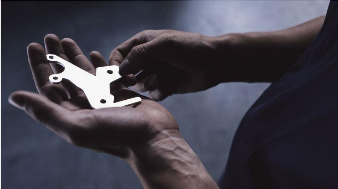
Der hohe Programmieraufwand, kippende Teile beim Schneidprozess, die komplizierte Teileentnahme und ein Nachbearbeitungsaufwand, waren Prozesshürden, die die TRUMPF Entwickler bei der TruLaser Center 7030 beseitigt haben. Perfekt für die filigranen, dünnen Teile, die bei Deeg durch die Fertigung laufen.
