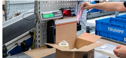
<p>Keine Fehler: Vor dem Versand prüfen die Mitarbeiter jedes Paket mit einer intelligenten Waage und vergleichen das Gewicht der Teile mit dem im System hinterlegten Wert.</p>
