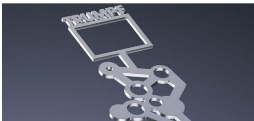
Beim Schmelzschnitzen schmilzt das Material in der Schnittfuge unter Schutzgasatmosphäre auf und die Schmelze wird durch den Gasdruck ausgetrieben.
