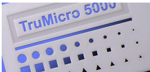
Bei Lünetten und Uhrengehäusen aus Keramik: Kein anderes Werkzeug als ultrakurzgepulstes Licht kann solche Konturen in Keramik mit solcher Geschwindigkeit und Präzision erzeugen.
