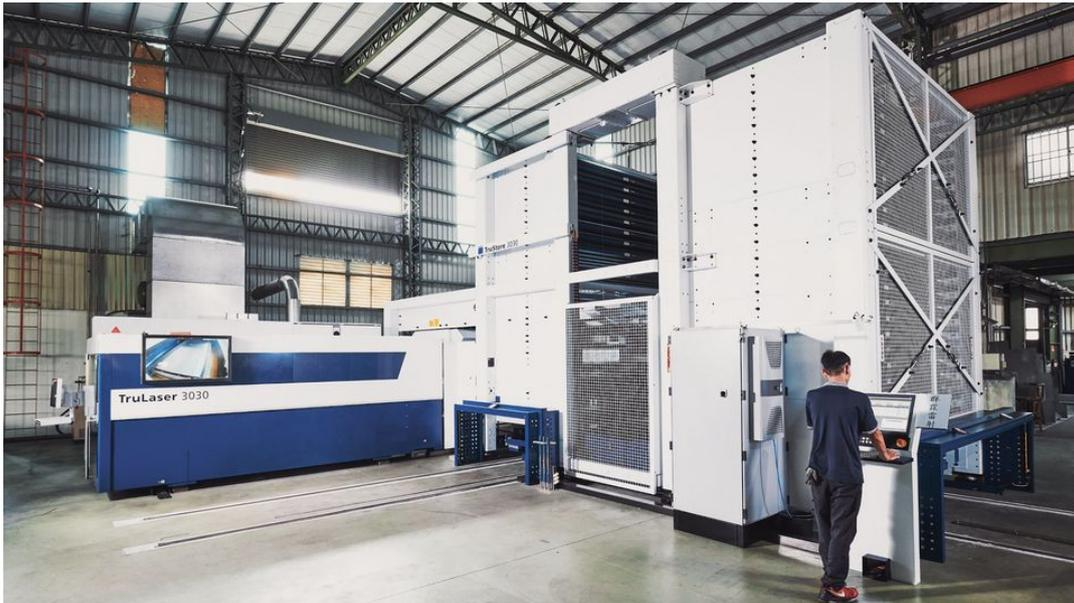
Zum Einstieg in die automatisierte Produktion entschied sich CHUN-LIN für eine TruLaser 3030 fiber mit Anbindung an ein TruStore 3030 Universallager. Das angeschlossene Universallager verfügt über zwei Lagertürme mit 31 Paletten für Großformatbleche von maximal 3.000 x 1.500 Millimeter.
