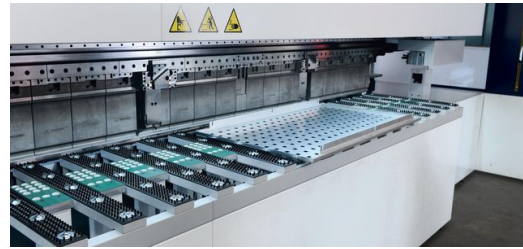
Gut gelöst ist die Bearbeitung von Lochblechen. Flexibel positionierbare Sauger oder optionale Magnethalter fixieren die Bleche unverrückbar. (Foto: KD Busch)
