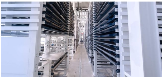
Das vollautomatisierte Stopa-Lager bei KNOLL ist 70 Meter lang und verfügt über 1.200 Lagerplätze sowie 13 Be- und Entladestationen. Foto: Stephen Duscher
