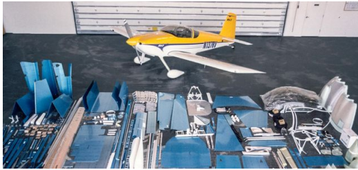
Van's Aircraft liefert alle Einzelteile in einer handlichen Box. Hobbypiloten weltweit bauen sie dann selbst zusammen. (Foto: Van's Aircraft)
