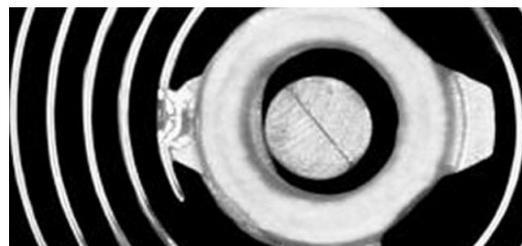
Der Schweißpunkt hat einen Durchmesser von 0,2 Millimetern
