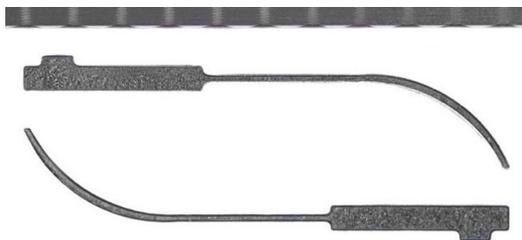
Pikosekundenlaser schneiden kleinste Feinmechanik-Bauteile ohne Verzug; hier eine Sekundenstoppfeder für Armbanduhren aus 0,05 Millimeter starkem Edelstahl.
