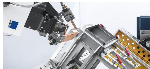
Das neue Verfahren FusionLine verbindet Teile auch dann, wenn Spalte überbrückt werden müssen. Es gleicht Ungenauigkeiten beim Schweißvorgang aus und schließt Spalte mit bis zu einem Millimeter Breite. Viele Bauteile, die für konventionelle Schweißverfahren konstruiert wurden, lassen sich so mit dem Laser bearbeiten. (Foto: Oliver Graf Fotostudio GmbH)
