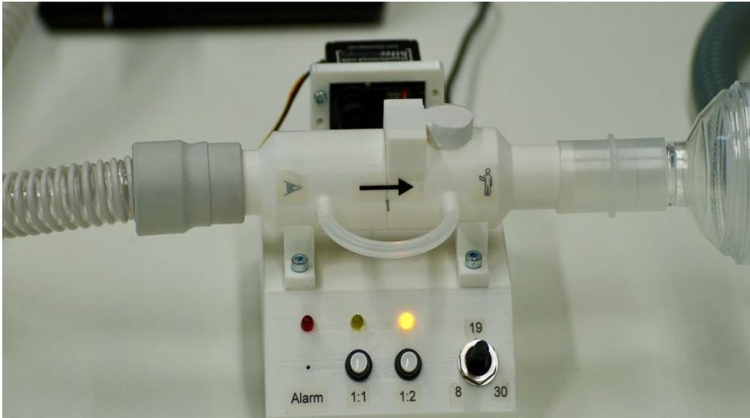
Im Projekt „The Breathing Project“ haben Forscher mit 3D-Druck einen Apparat entwickelt, mit dem sich ein Schnarchgerät zum Beatmungsgerät erweitern lässt. Dieses soll bei der Versorgung von Corona-Patienten helfen. (Quelle: Universität Marburg)
