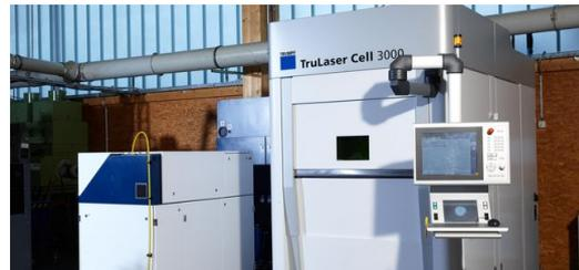
„Die Kantenqualität ist mit dem Werkzeug Festkörperlaser auch bei dickeren Materialien genauso gut wie mit dem CO<sub>2</sub>-Laser“, unterstreicht Franz Biegert, LICOS Trucktec. Bild: Florian Bilger Fotodesign
