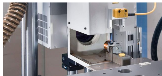
<p>Zuvor entfernte der TruMark 5010 Laser den Isolierlack von dem Kupferdraht. Anschließend wurde die Spule kontaktiert.</p>
