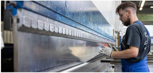
Bei der Fertigung von Sonderprofilen kommt die Automatisierung an ihre Grenzen. Sie werden bei SCHRAG auch künftig von Kantprofilen an Biegepressen bearbeitet. Am SCHRAG Standort Hamburg Seevetal komplettiert eine 12,5 Meter Presse von TRUMPF die vorhandene Pressenstraße.
