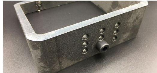
<p>Mit der TruLaser Tube 7000 lassen sich verschiedene Gewinde einbringen.</p> – Peter Klingauf
