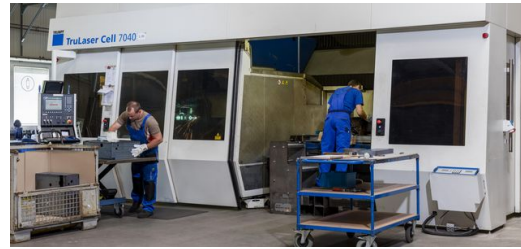
Mit der TruLaser Cell 7040 gelingen Sichtnähte mit bester optischer Güte. Die Mitarbeiter sind in der Lage, auch komplizierte Vorrichtungen innerhalb einer Woche zum Einsatz zu bringen. Bild: Jan Gutzeit
