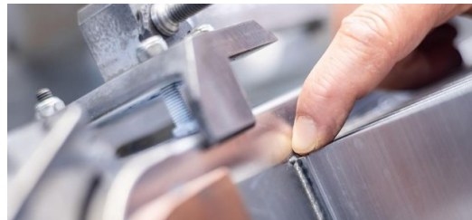
Die Schweißnähte der Gehäuse müssen absolut dicht sein, sodass die Elektronik des Wechselrichters bestens vor Umwelteinflüssen geschützt ist.
