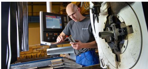
Täglich sind ein bis zwei Programmierer mit der Vorbereitung von zwei Schichten beschäftigt. Die Software TruTops Tube ermöglicht die exakte Berechnung von Schnittgeometrien. Bild: Escherich Fotografie
