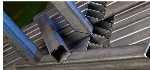
Das Technologiepaket Schrägschnitt ermöglicht hochwertige 45° Schnitte – und das aufgrund der hohen Schneidgeschwindigkeit hochproduktiv. Bild: Escherich Fotografie
