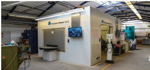
<p>Hallo Mr.Robot: Der TruLaser Robot 5020 hilft Gefinal dabei, anspruchsvolle Schweißarbeiten umzusetzen.</p> – Christian Mader
