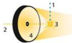
Das Prinzip der EUV-Gewinnung: In eine Vakuumkammer fallen pro Sekunde 50.000 kleinste Zinntröpfchen (1). Ein Puls aus einem CO<sub>2</sub>-Laser (2) trifft jeden Tropfen und verwandelt ihn in Plasma (3). Dadurch entsteht EUV-Licht, das dann per Spiegel (4) auf die zu belichtenden Wafer gelenkt wird.
