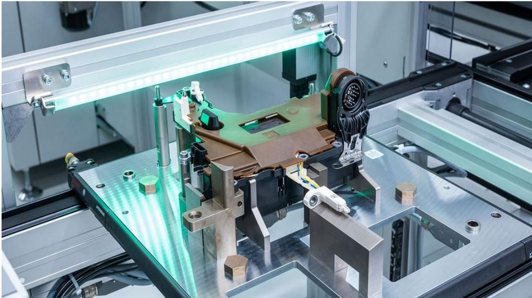
Der braune Kunststoffdeckel wird mit 22 Schweißstegen auf die Getriebesteuerung geschweißt.
