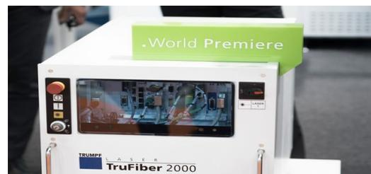
Der faserbasierte Festkörperlaser TruFiber 2000 feierte auf der LASYS 2018 Weltpremiere. Auch er trägt durch den kompakten Laseraufbau und den flexiblen Schnittstellen zu allen gängigen Feldbussystemen und der höchstmöglichen Lasersicherheits-Klassifizierung mit Performance Level e zu einer einfachen Integration bei.
