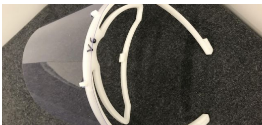
Die TruLaser Cell 7040 von TRUMPF schneidet täglich 1000 Kopfbügel für Gesichtsschilde.
