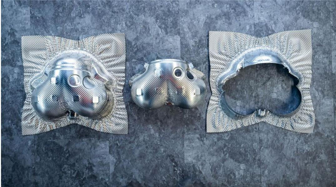
Tiefgezogene Form der Edelstahlumschalung (links), 3D-gelaserte Endform (Mitte) und abgeschnittener Überstand (rechts).
