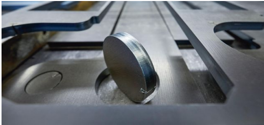
Die Option BrightLine fiber erreicht in 25 Millimeter dickem Baustahl hervorragende Schnittkanten bei beeindruckender Schneidgeschwindigkeit. In mittleren und dünnen Blechen beweist der 8-kW-Laser seine Power noch eindrucksvoller. (Foto: Claus Langer)
