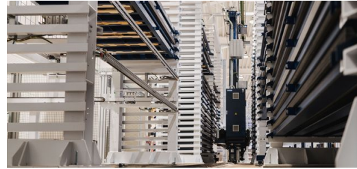
Das Großlagersystem: STOPA schickt das Blechmaterial vollautomatisch auf seine Fertigungsreise und holt die fertigen Teile ebenso effizient wieder zurück.
