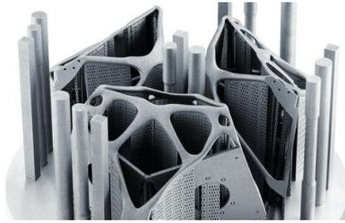
In der Luft- und Raumfahrt kommt es — wie hier bei diesem Satellitenbauteil — auf ein hohe Steifigkeit bei gleichzeitig geringem Gewicht an.
