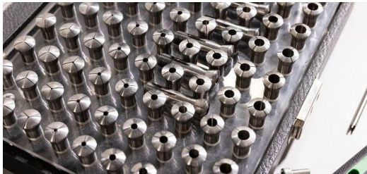
<p>Dank hochflexibler Werkzeuge dauert das Einrichten der Teilehalterung und das Ausrichten der Optiken weniger als fünf Minuten: Hier die Werkzeuge zur Teilehalterung.</p>
