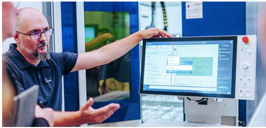
Bedienpanel: Vorführtechniker Uli Schrade demonstriert am Display, wie alle Sicherheitsparameter auf einen Blick sichtbar sind – bevor der Laser sicher starten kann.
