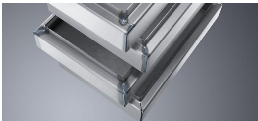
<p>Klemmenkasten aus Baustahl (von unten nach oben): ungeschweißt, MAG-handgeschweißt, FusionLine-geschweißt und lasergerecht umgestaltet und lasergeschweißt. (Foto: Oliver Graf Fotostudio GmbH)</p></p></p>
