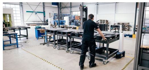
Sensoren an der Docking-Station erkennen, wenn eine Palette oder eine Gitterbox eingeparkt wird und melden das direkt an die TRUMPF Software TruTops Fab, die dann die automatische Transportsteuerung übernimmt. (Bild: Cornelius Bierer)
