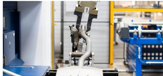
Las instalaciones del conjunto de máquinas funcionan automáticamente mediante un sistema robot que transporta las piezas automáticamente de un paso de mecanizado al siguiente.
