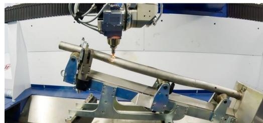
Con el sistema láser 3D TruLaser Cell 8030 de TRUMPF pueden recortarse contornos precisos que no se pueden introducir antes del plegado porque, de lo contrario, se deformarían.
