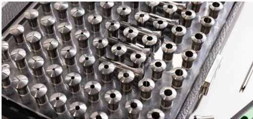
Gracias a útiles altamente flexibles, la preparación del portapiezas y la alineación de las ópticas dura menos de cinco minutos. Aquí podemos ver los útiles para el portapiezas.
