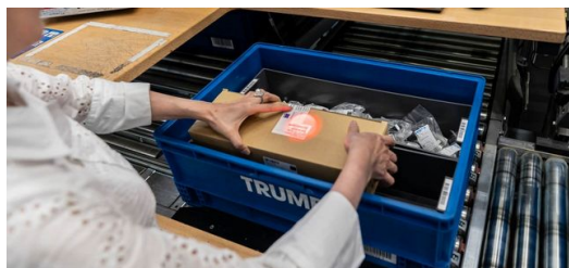
<p>Asistencia digital: una marca luminosa de color indica a los empleados qué componentes deben colocar en cada caja.</p>
