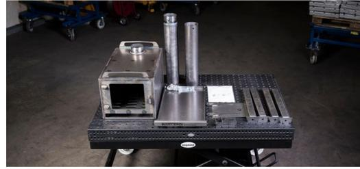
La estufa de campaña para Ucrania consta de 22 piezas individuales. Todas ellas se cortaron con el láser, se plegaron y soldaron posteriormente de forma automatizada. El tirador de la estufa se utiliza como destornillador con el que se pueden atornillar las diferentes piezas individuales.
