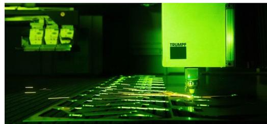
La seguridad del proceso es clave para Hans Sanders y por eso está entusiasmado con el concepto de seguridad de la TruLaser Center 7030. El SmartGate integrado en la mesa de cepillos impide, por ejemplo, que las piezas vuelquen durante el proceso de corte.
