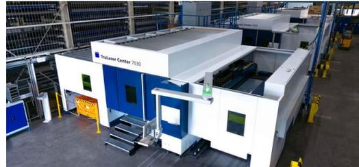
La automatización y la digitalización son la clave del éxito para VDL. Las tres TruLaser 7030 de TRUMPF con láseres totalmente automáticos encajan a la perfección en el concepto. Se encargan de todos los procesos relacionados con el corte por láser de forma totalmente automática.
