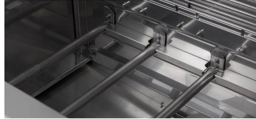
Las cuatro varillas de acero inoxidable de los quemadores de las parrillas de gas se cortan en una máquina de corte de tubos por láser TRUMPF y cuentan con 144 agujeros cada una. El diámetro de los agujeros, que disminuye hacia la parte posterior, garantiza un calentamiento uniforme de toda la parrilla.
