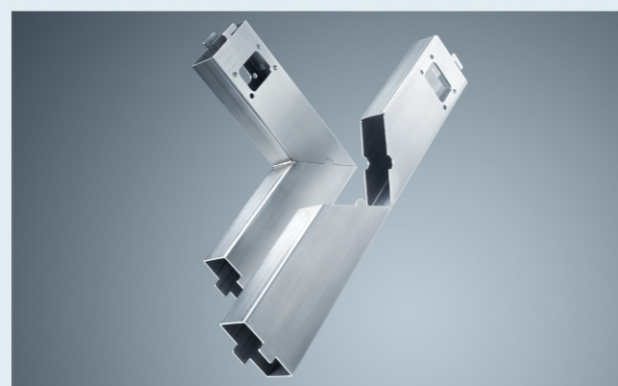
使用激光切割, 通过标记辅助定位达到精确的斜面接合
