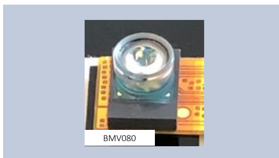
图 16: 微型PM2.5模块，它带有三个VCSEL、光学器件和ASIC。(BMV080由Bosch Sensortec生产)。
