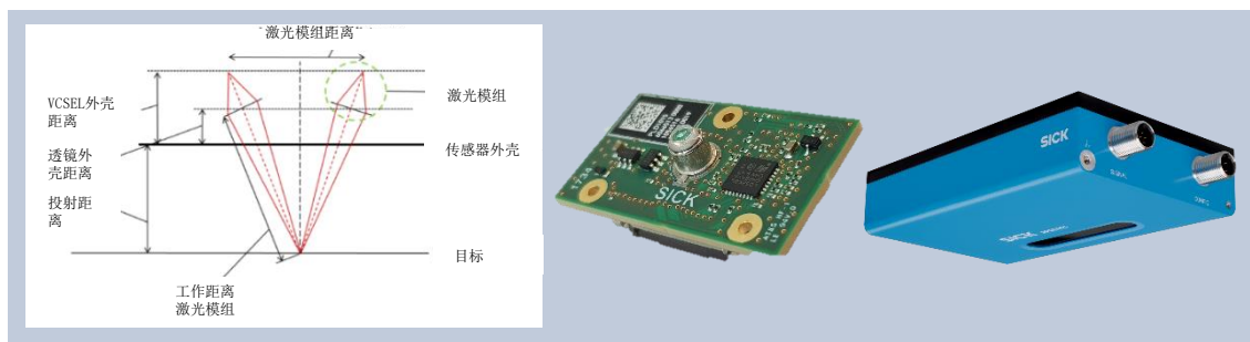
图 12： 左：编码器中配有2个SMI传感器。 中：带有透镜和电路的VCSEL, TO包装。 右：编码器产品 SEPTEC, SICK公司出品。
