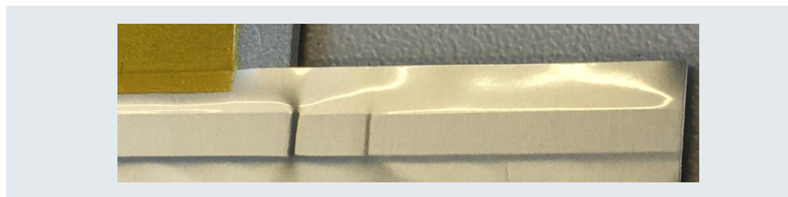
图 5： 使用VCSEL加热 系统的加工效果。 电池接点处无褶皱 密封。
