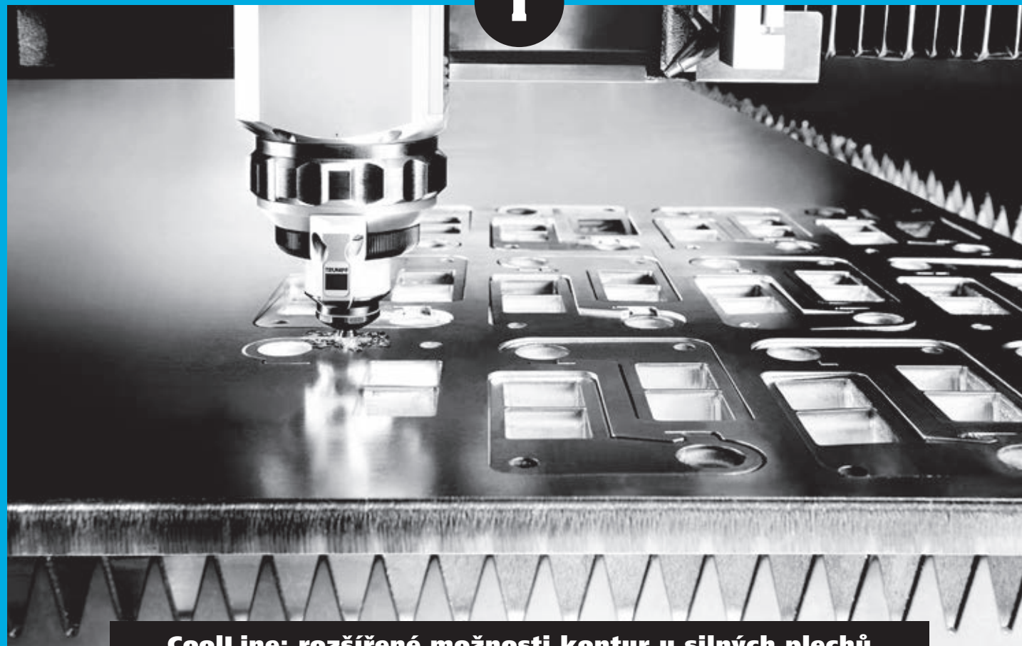
CoolLine: rozšířené možnosti kontur u silných plechů
