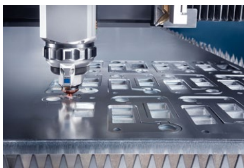
S CoolLine řežete dokonce úzké obrysy v silné konstrukční oceli a navíc zvýšíte procesní bezpečnost.
